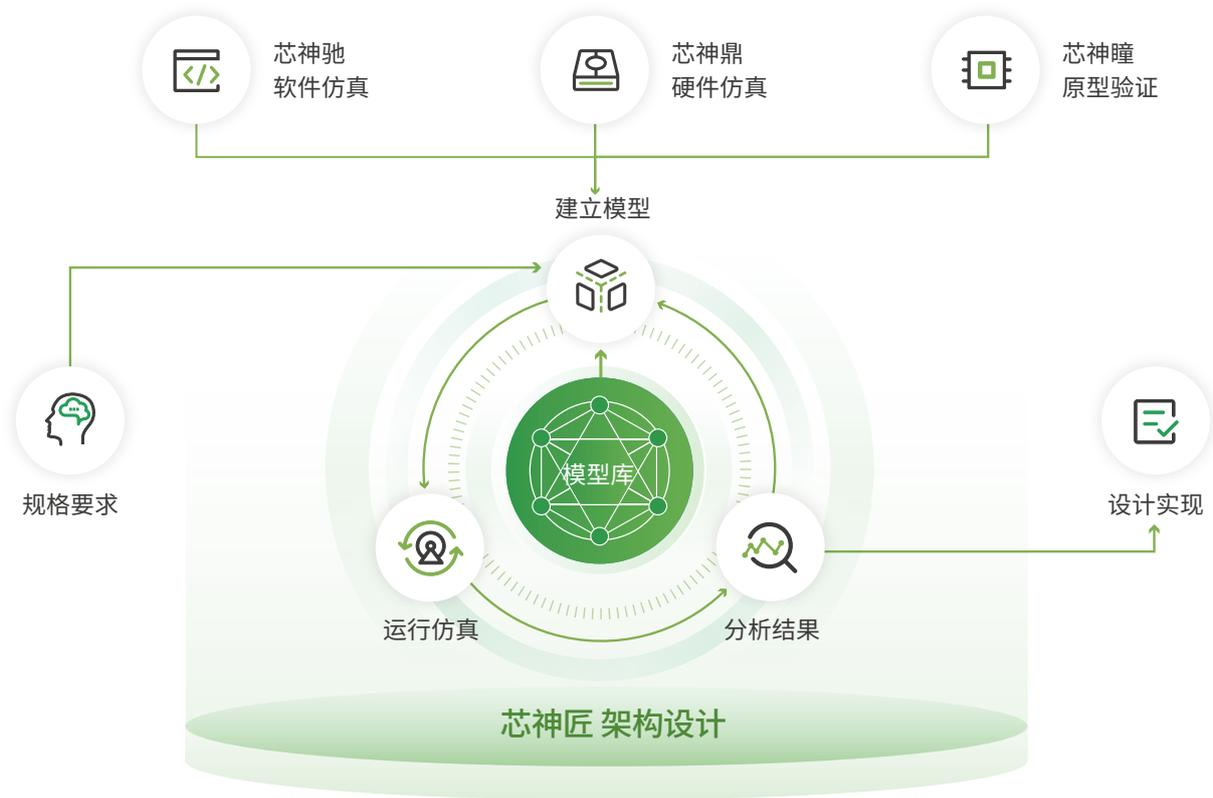
芯神匠架构设计软件不仅是一个全面的建模、分析和仿真平台，还能实现软硬件的高效协同工作。该软件能与芯神鼎、芯神瞳等EDA工具搭配，支持运用既有IP模块进行高精度的建模和仿真。
